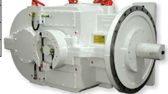
与减速器配套的限矩器和 链子张紧装置
